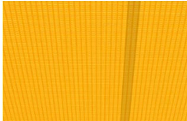
**Geklebte Markisentücher** Mit Ultraschall verschweißte Bahnverbindungen sorgen für ein homogenes Erscheinungsbild. Die hervorragende Wasser-, Licht- und Temperaturbeständigkeit verlängert die Lebensdauer des Tuches.
